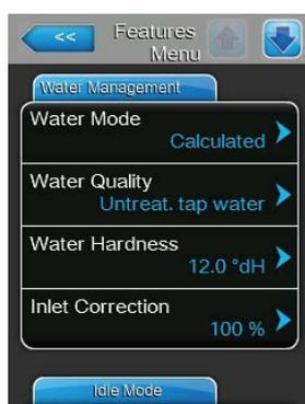
Les paramétrages suivants apparaissent uniquement lorsque le "**Water Mode**" est réglé sur "Calculated".
