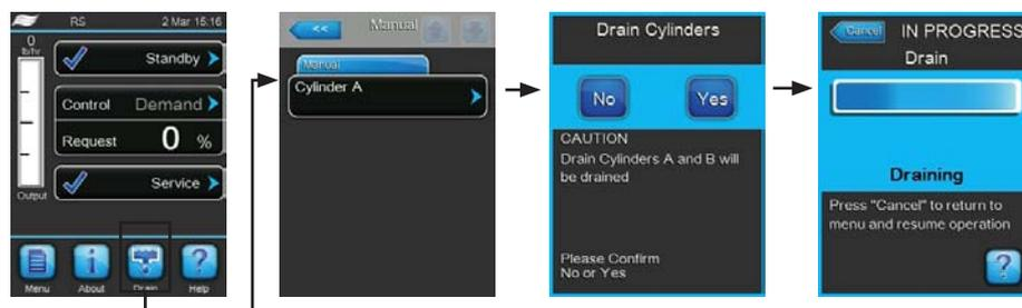
1. Au niveau de l'affichage de fonctionnement standard, appuyez sur **<Drain>** (Rinçage).
