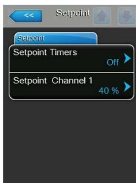
Laissez la fonction Timer désactivée (Setpoint Timers: "Off") ou désactivez la fonction Timer si nécessaire. Définissez ensuite la valeur de consigne d'humidité déterminée avec le paramètre "Setpoint Channel 1" (Réglage d'usine : **40 %hr**, Plage de réglage : **5...95 %hr**).
