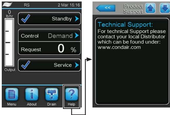
Dans l'affichage de fonctionnement standard, appuyez sur **<Help>** (Aide). La fenêtre d'informations de support technique s'ouvre.
