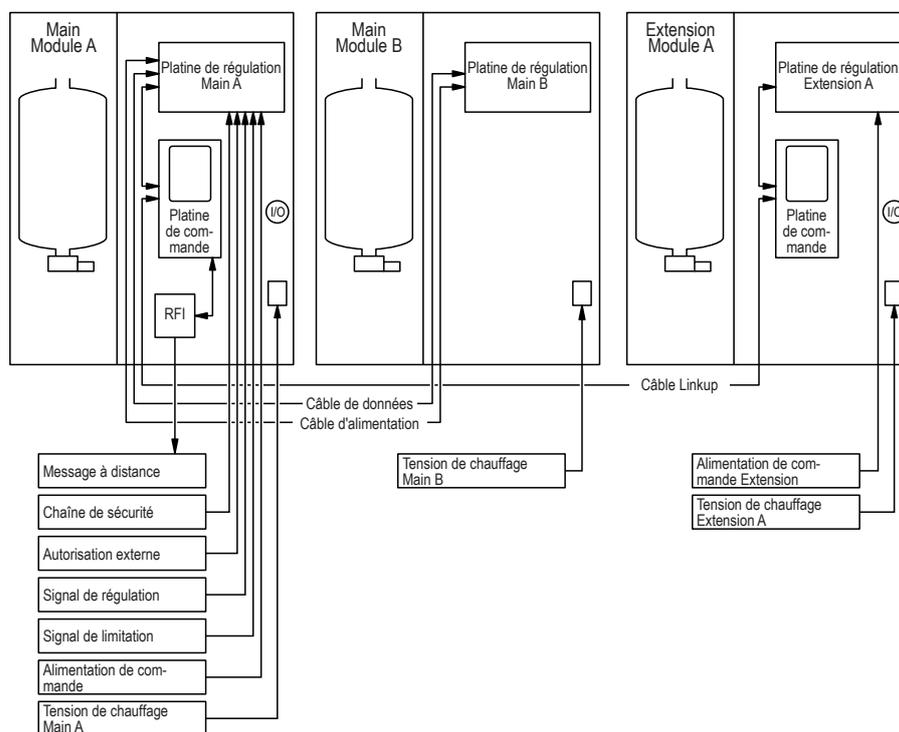
Fig. 4 : Aperçu systèmes Linkup (3 x "M")
