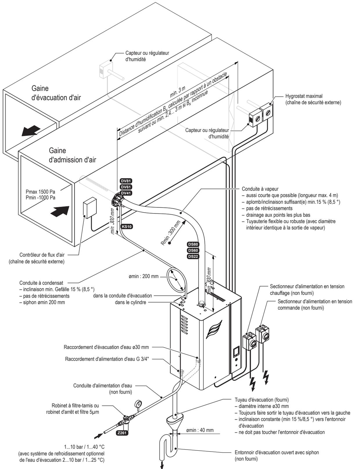
Fig. 7 : Installation typique pour humidification de gaine
