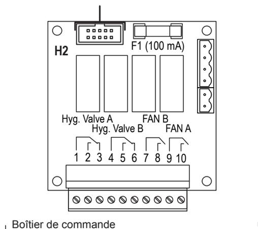
La platine optionnelle supplémentaire dispose de quatre contacts de relais sans potentiel pour le pilotage d'un ventilateur externe dans le système de ventilation et d'une vanne optionnelle pour le rinçage de la conduite d'arrivée d'eau :
