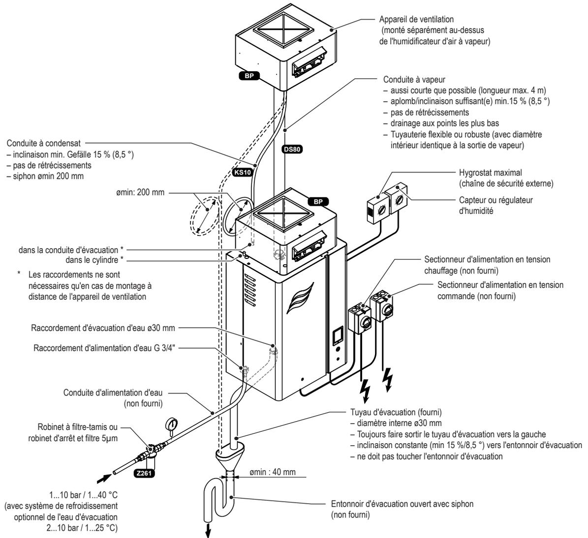
Fig. 8 : Installation typique pour humidification directe de local
