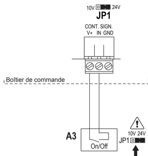
Le câble de signal d'un hygrostat Marche/Arrêt 24 V est connecté aux contacts "V+" et "IN" sur la platine de régulation de l'unité de commande conformément au schéma.
