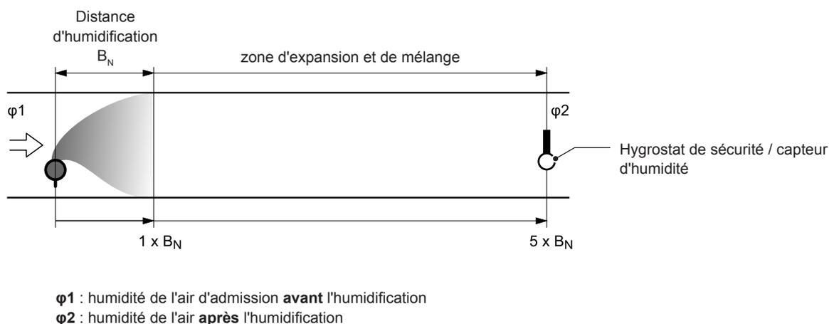
Fig. 16 : Distance d'humidification "B<sub>N</sub>"
