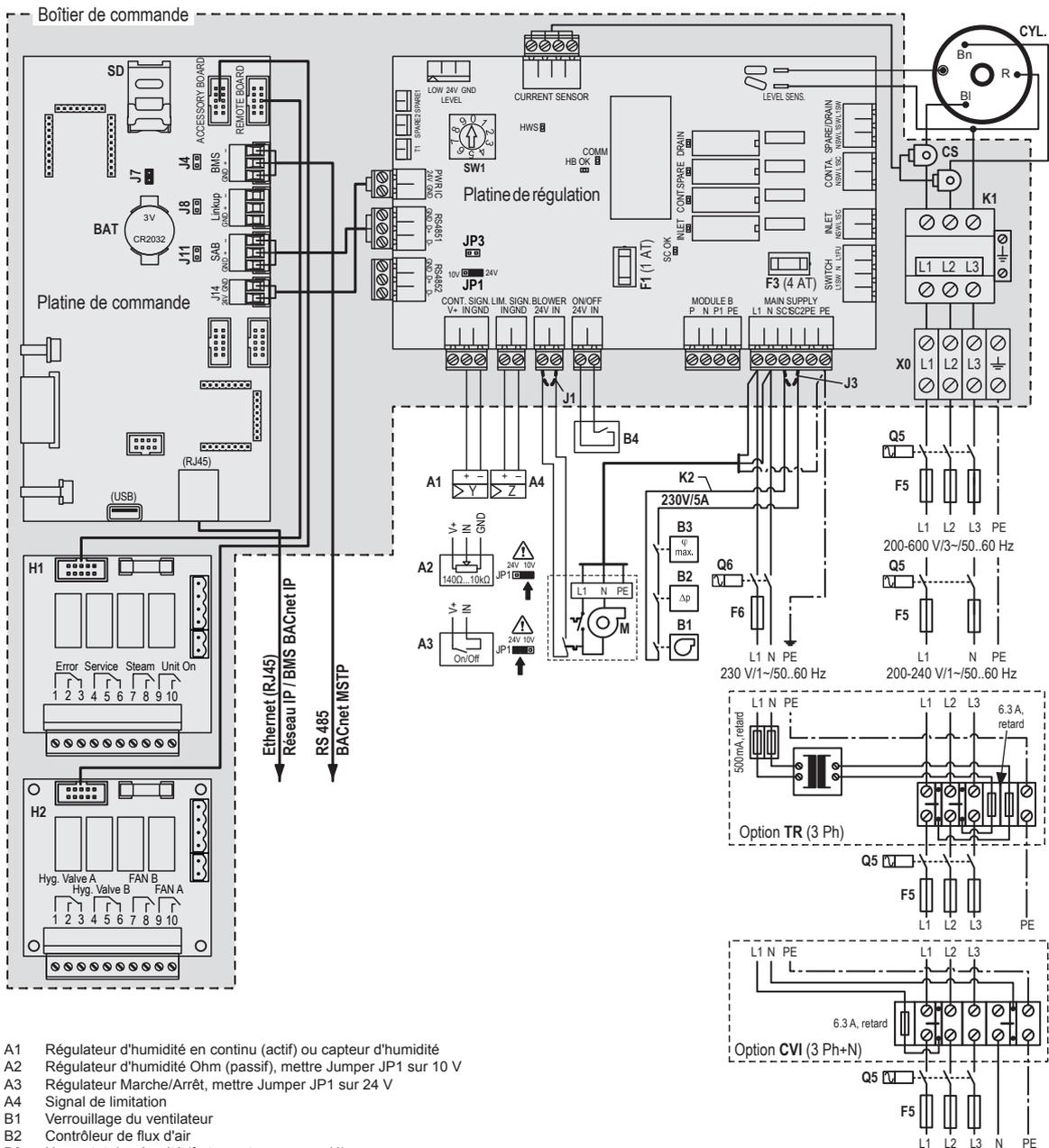
Fig. 27 : Schéma électrique Condair EL 5...45 - Appareils individuels Petits ("S") et Moyens ("M")
