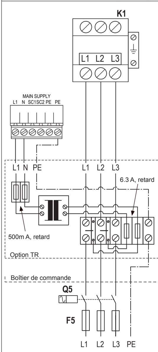
Le raccordement de l'alimentation en tension chauffage (L1, L2, L3 et PE) se fait sur les bornes correspondantes de l'option TR conformément au schéma. Le câble de raccordement doit absolument être amené jusqu'à l'unité de commande via la fixation de serrage.
