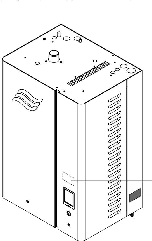
Fig. 6 : Placement de la plaque signalétique
