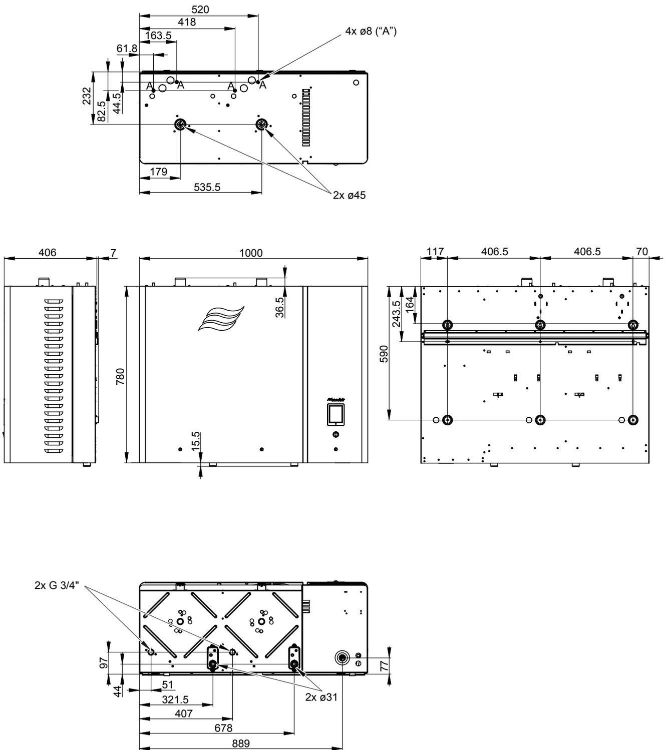
Fig. 33 : Dimensions Condair EL 50 - 90, taille de boîtier "L" (mesures en mm)
