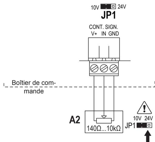
Le câble de signal d'un régulateur d'humidité Ohm (140 Ω...10 kΩ) est connecté aux contacts "V+", "IN" et "GND" sur la platine de régulation de l'unité de commande conformément au schéma.
