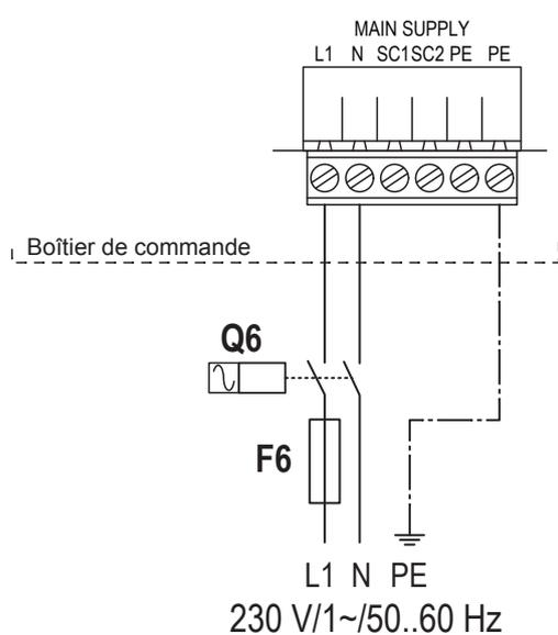
Le raccordement de l'alimentation en tension commande (L1, N, PE) se fait sur les bornes correspondantes de la platine de régulation conformément au schéma.
