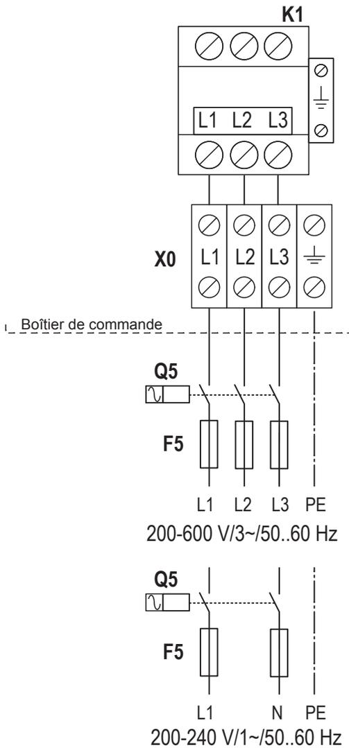
Le raccordement de l'alimentation en tension chauffage (L1, L2, L3, N et PE ou L1, N et PE) se fait sur les bornes correspondantes du contacteur principal "K1" conformément au schéma (ou sur les bornes correspondantes de la barrette à bornes "X0"). Le câble de raccordement doit absolument être amené jusqu'à l'unité de commande via la fixation de serrage.
