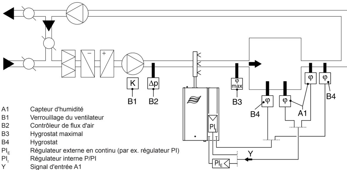
Fig. 24 : Système 1 – Régulation de l'humidité ambiante
