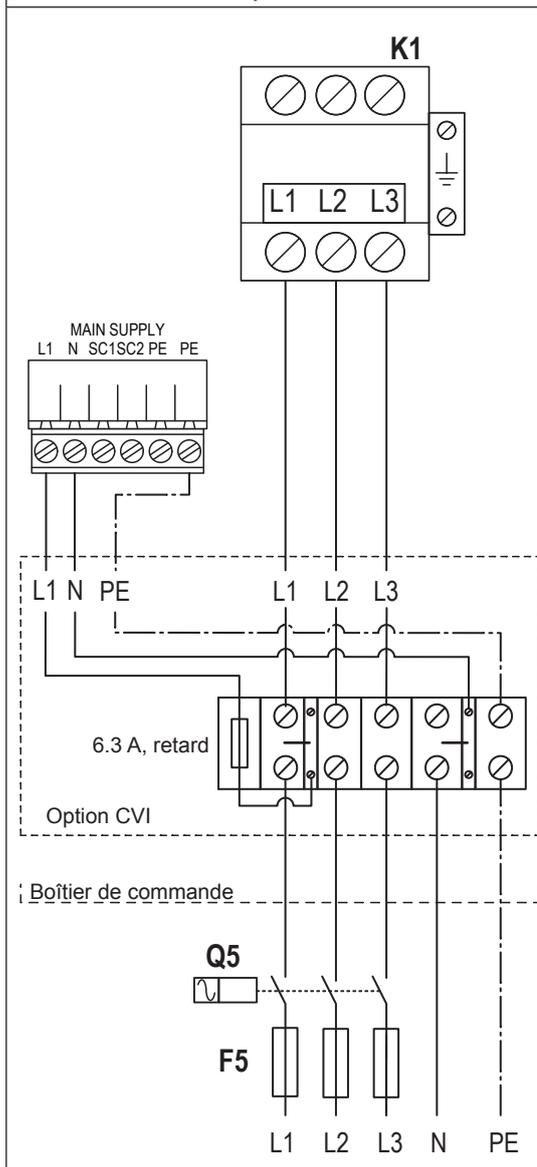
Le raccordement de l'alimentation en tension chauffage (L1, L2, L3, N et PE) se fait sur les bornes correspondantes de l'option CVI conformément au schéma). Le câble de raccordement doit absolument être amené jusqu'à l'unité de commande via la fixation de serrage. Remarque : dans le cas des appareils doubles, seul le module A (master) – et dans les systèmes Linkup, seuls le module A (master) et le module A d'extension (slave) – est/ sont connecté(s) via l'option CVI.
