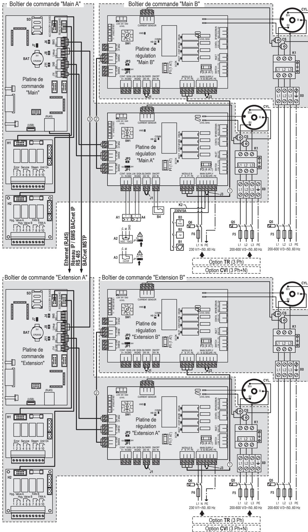
Fig. 30 : Schéma électrique Condair EL - Systèmes Linkup 100...160 kg/h
