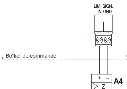
Le câble de signal d'un limiteur externe est connecté aux bornes "IN" (+) et "GND" (-) sur la platine de régulation de l'unité de commande.
