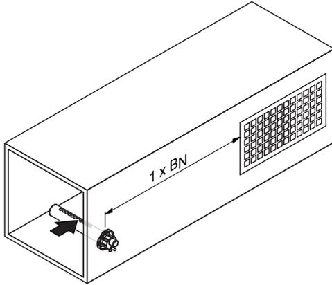
**avant hygromstat de sécurité / capteur d'humidité**
