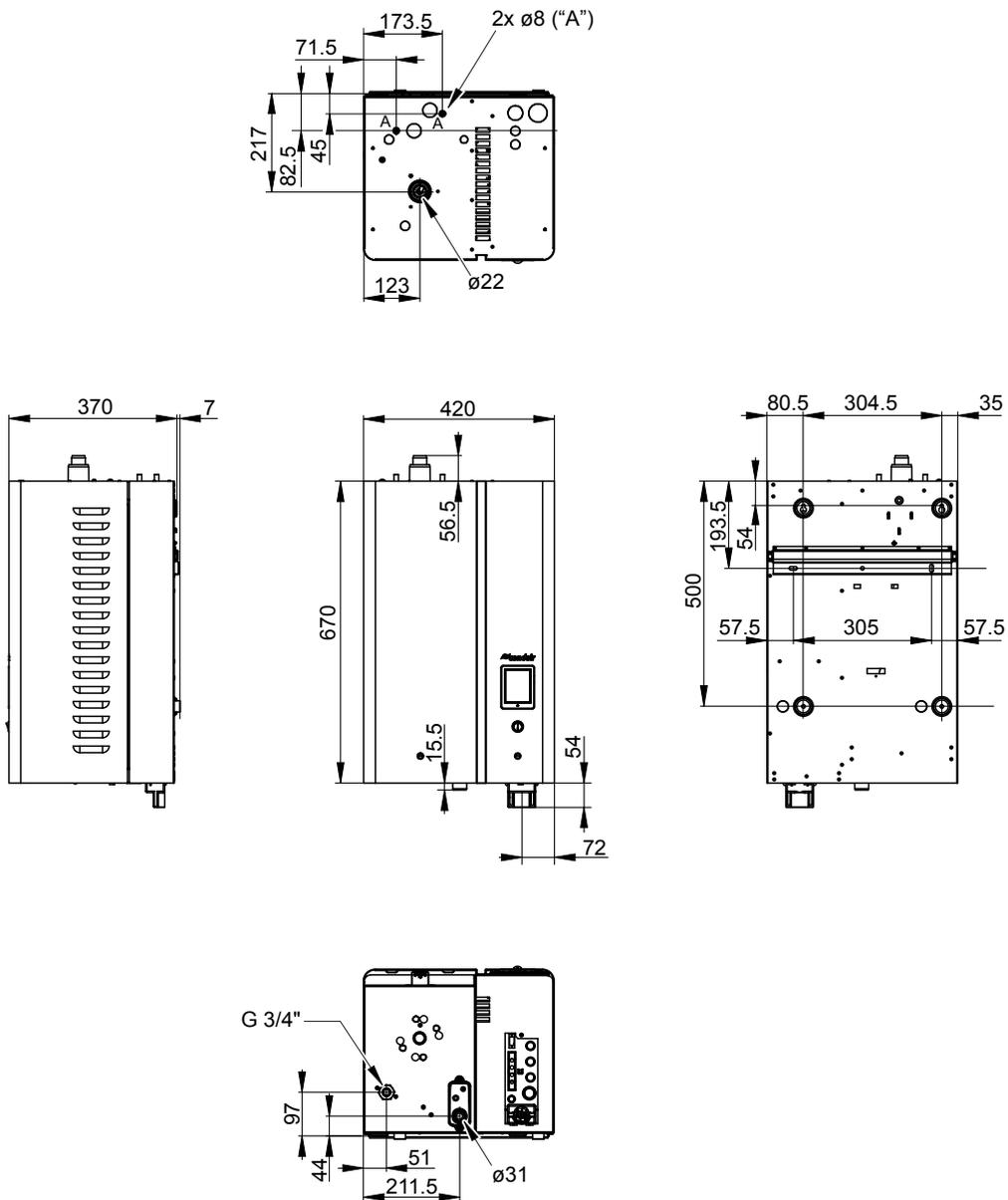
Fig. 31 : Dimensions Condair EL 5 - 15, taille de boîtier "S" (mesures en mm)
