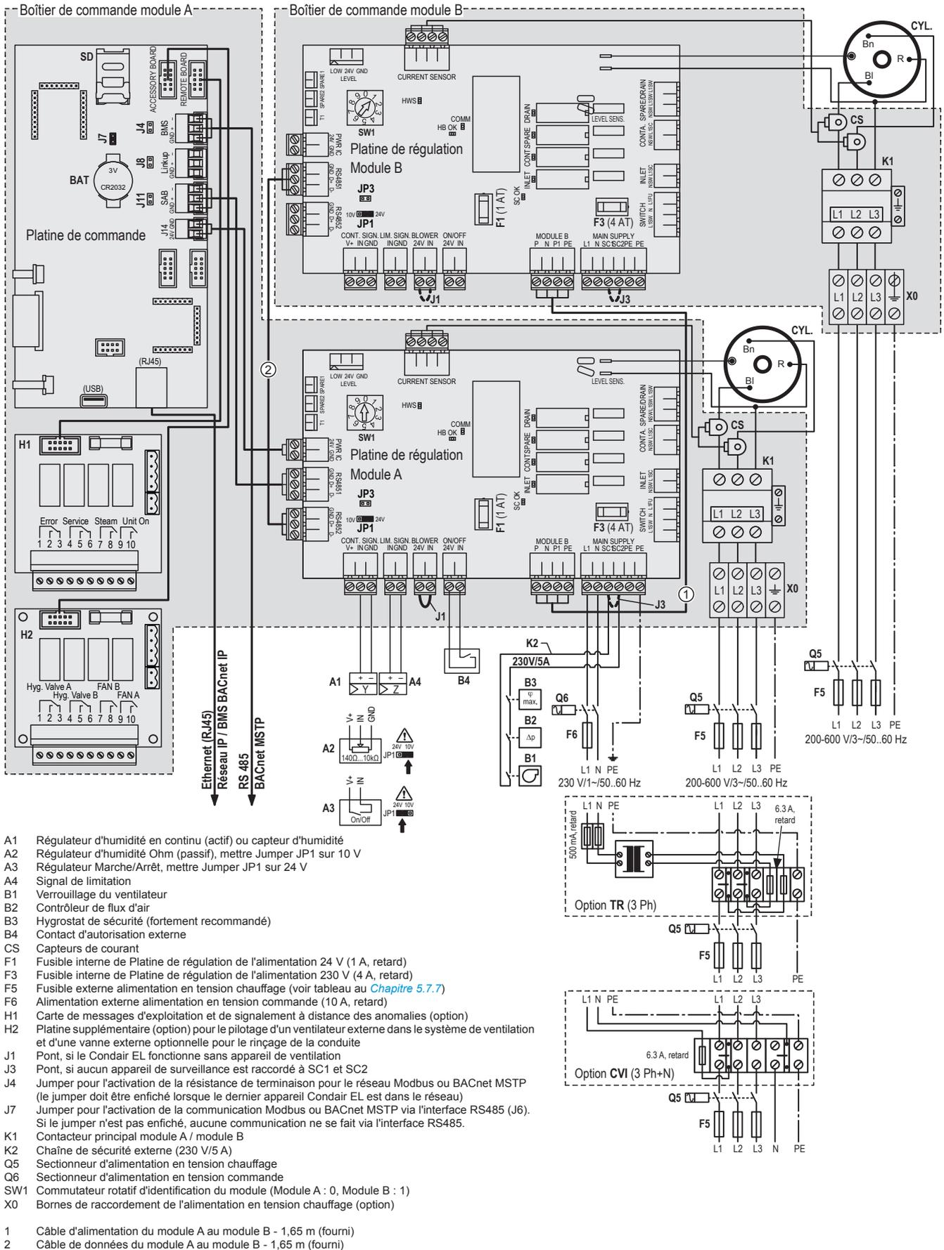
Fig. 29 : Schéma électrique Condair EL - Appareils doubles (2 x "M") 40...80 kg/h
