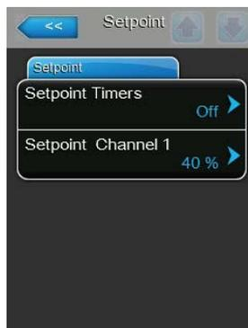
Laissez la fonction Timer désactivée (Setpoint Timers: "**Off**") ou désactivez la fonction Timer si nécessaire. Définissez ensuite la valeur de consigne d'humidité déterminée avec le paramètre "Setpoint Channel 1" (Réglage d'usine : **40 %rF**, plage de réglage : **5...95 %rF**).
