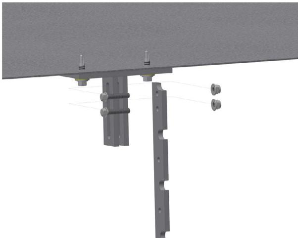
*Fig. 24: Montage de la fixation de gaine*
