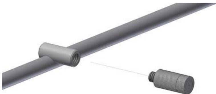
Fig. 27: Insertion des buses
