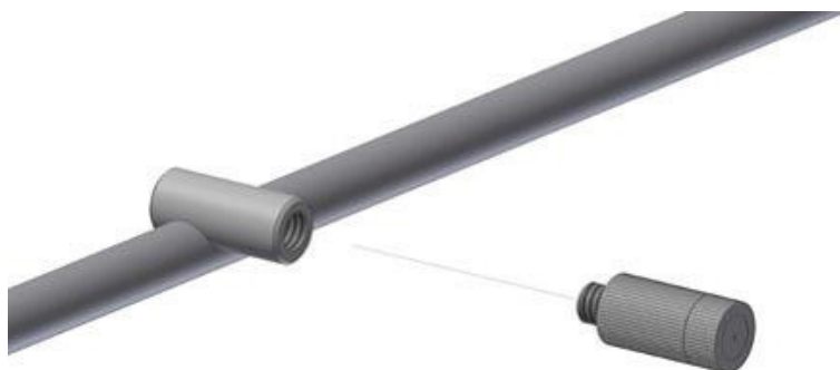
Fig. 27: De sproeikoppen plaatsen
