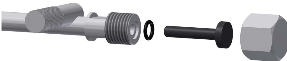
Fig. 29: Uiteinden van de leidingen dichtstoppen
