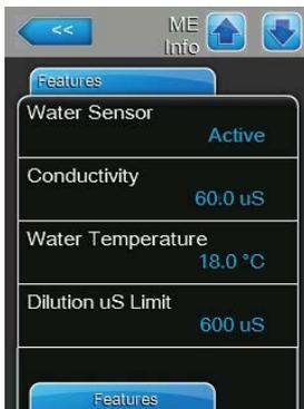
Mode de dilution configuré sur "**Condu & Temp**" (dilution de la conductivité et de la température) :
