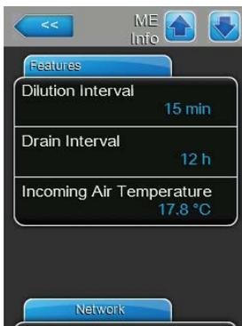
Mode de dilution configuré sur "**Dilution Interval**" (dilution d'intervalle) :
