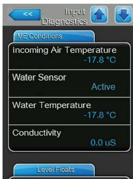
La section relative aux conditions ME indique les paramètres de fonctionnement des options installées :
