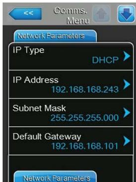
Les paramètres réseau présentés ci-dessous sont utilisés pour assurer des fonctions de communication par l'intermédiaire de l'interface intégrée du contrôleur du Condair ME Control.
